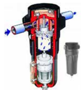
Filtr wirowy cyklonowy. Woda w stanie ciekłym Źródło: Parker - ZANDER
