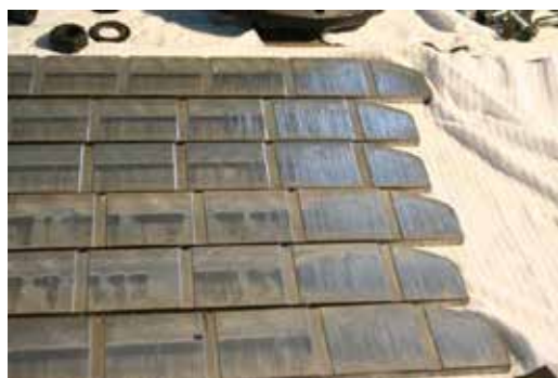
Rys. 1. Gładź cylindra zniszczona przez twarde zanieczyszczenia, które zostały przepuszczone przez nieodpowiedni filtr powietrza. Źródło: GRADOS
