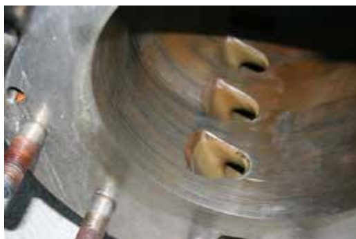
Rys. 2. Wyraźne ślady zacierania przy końcach łopatek spowodowane za niskim ciśnieniem w układzie olejowym, związanym z zastosowaniem nieodpowiednich filtrów oleju. Źródło: GRADOS
